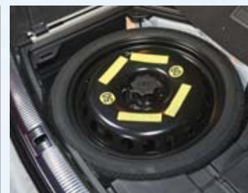
TESTIRYHMÄN autoissa on varauduttu renkaan puhkeamiseen kolmella eri tavalla. Pääsääntöisesti tavaratilasta löytyy pienikokoinen vararengas tai paikkaussarja, mutta BMW:ssä on runflat-renkaat.
