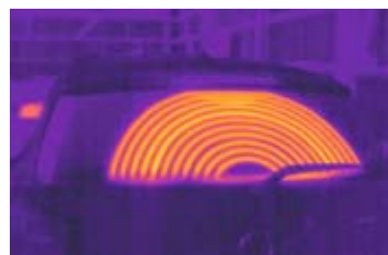
BMW:N takaikkunaa tarkasteltaessa näyttää siltä, että vastukset lämmittäisivät koko lasin, mutta lämpökamerakuva kertoo totuuden: lämmitys toimii vain pyyhkimen alueella. Takalasiin on integroitu myös toinen osa antennista, joka näyttää lämmitysvastukselta.
