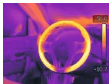
OTIMME lämpökamerakuvan 50-asteisesta Hyundain ohjauspyörästä. Testin aikana haistimme vienoa palaneen hajua, kun lämmitintä käytettiin.
