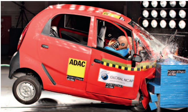
↑ TATA Nano osoittautui kolaritestissä varsin heppoiseksi. Muissakaan Intian markkinoille suunnatuissa halpamalleissa ei ole kehumista.
